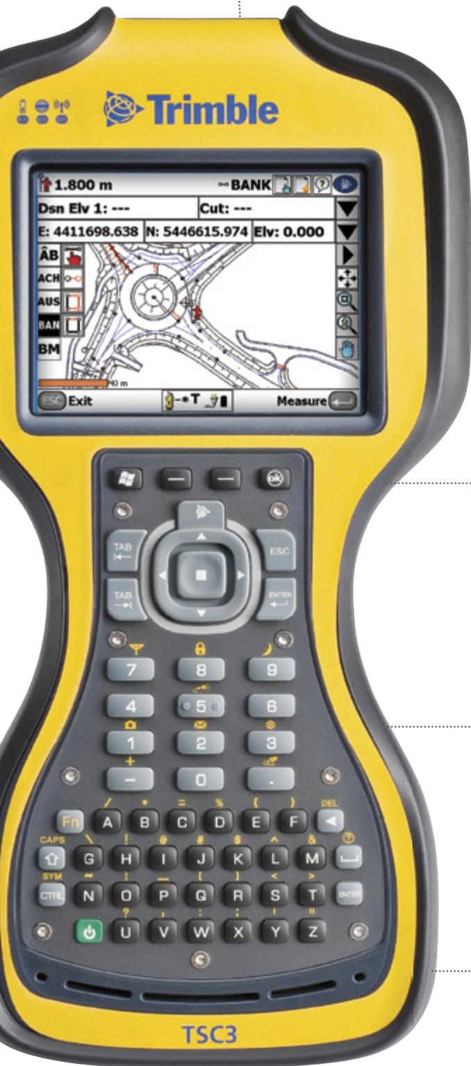
4.2英寸高分辨率LCD大触摸屏和字母数字键盘，易于输入数据
